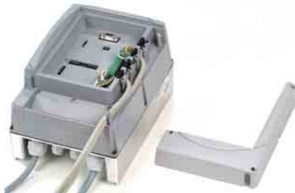
Obrázek 14: Demontáž krytu pro řídicí rozvody
