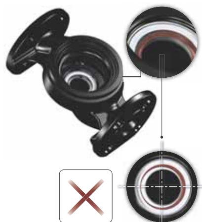
Obr. 9 Nesprávně vystředěná těsnící soustava
