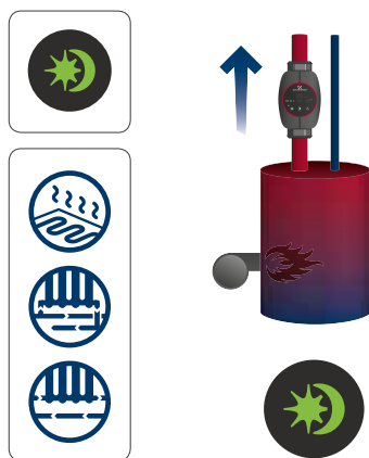
Obr. 21 Podmienky automatickej nočnej redukovanej prevádzky
