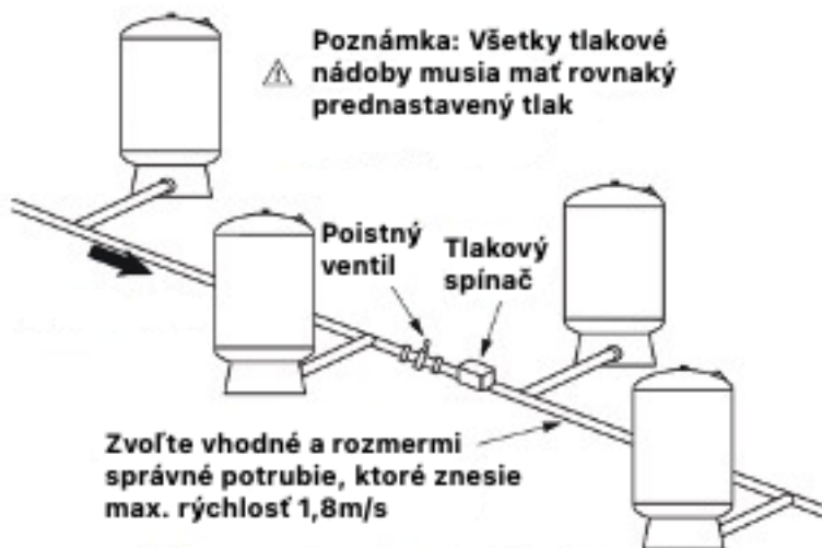
Obr. 1.5 Inštalácia viacerých tlakových nádob
