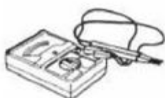
Вольтметр переменного тока
