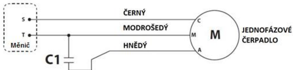
Obrázek 11: Schéma zapojení jednofázového motoru
