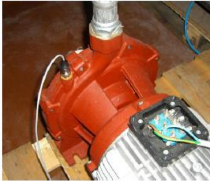
Obrázek 4: Příklad nalévacího otvoru výtlaku čerpadla s namontovaným tlakovým čidlem
